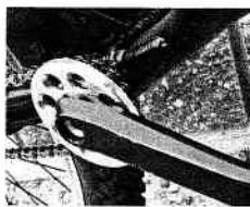
リングガードはクランクに取り付けるケースが多い
